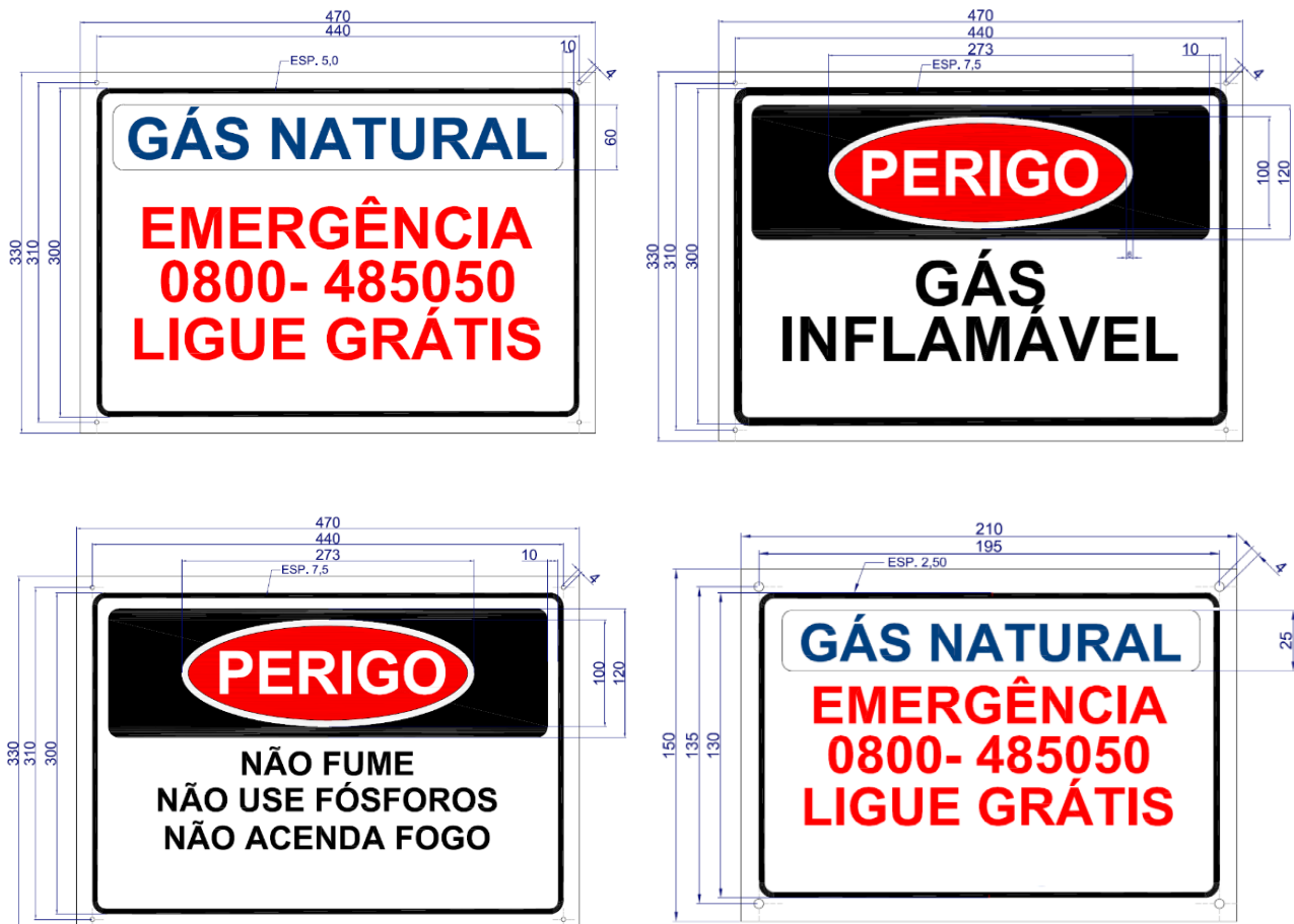
Figuras 2 – Placas de sinalização do Conjunto de Regulagem e Medição de GN (CRM)
