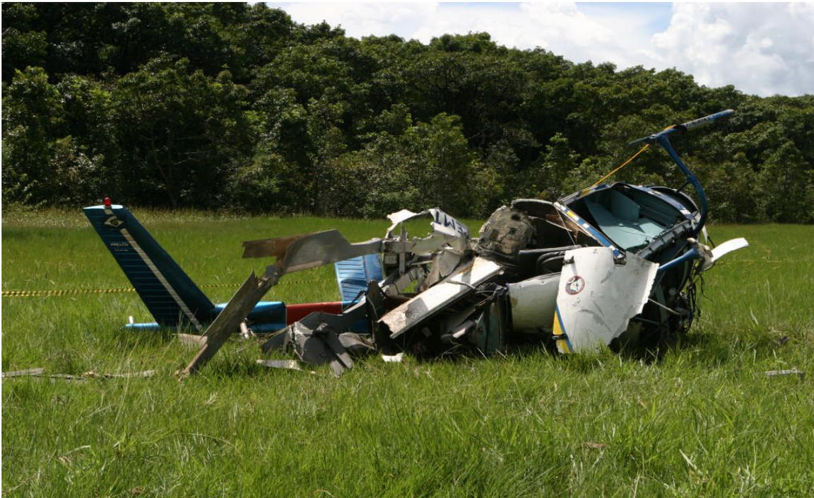
Situação da aeronave após a colisão com o terreno em vôo controlado.
